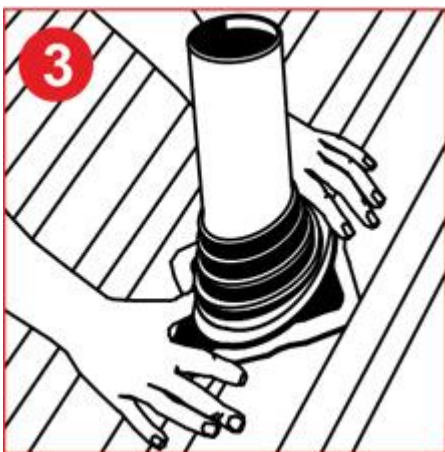
3. Выровняйте фланец по форме кровли
